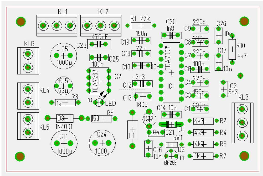
FLF-Radio V2010 - Bestückung der Platine
